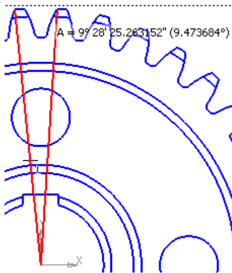
Рис. 4. К замеру углового шага p^\circ
